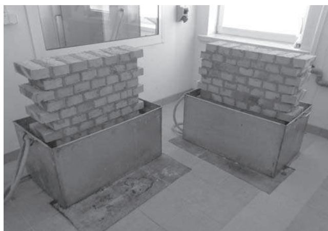
Rys. 1. Mury badawcze przygotowane do iniekcji w metodzie ITB
