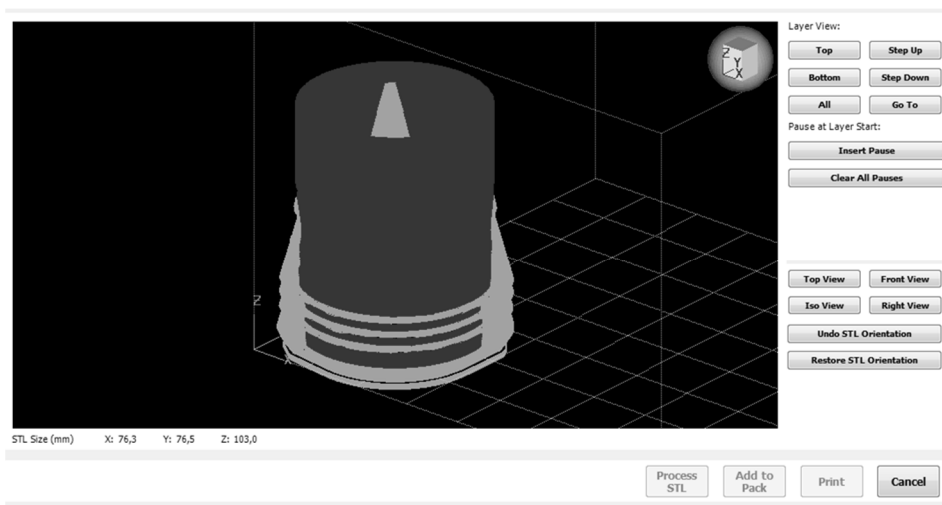
Rys. 5. Przetwarzanie pliku STL w celu wyznaczenia ścieżek przejścia głowicy drukarki 3D
