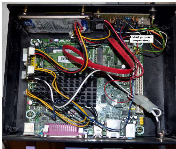
Rys. 4. Rejestrator temperatury zbudowany w oparciu o płytę główną miniPC z zaznaczonym układem pomiaru temperatur
