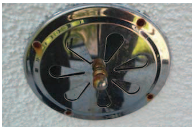
Fot. 1. Korozja galwaniczna wkrętów wykonanych z ocynkowanej stali w kontakcie ze stalą nierdzewną
