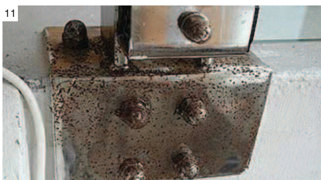
Fot. 7–12. Przebarwienia, rdzawe plamy i wżery korozyjne na stalowych elementach pływalni powstałe na skutek zastosowania nieodpowiedniego gatunku stali do warunków eksploatacji i/lub niewystarczającej konserwacji
