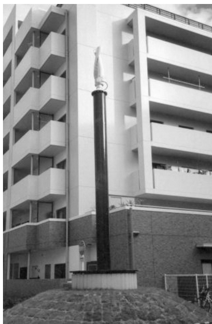
Rys. 7. Nowoczesna odmiana konstrukcyjna turbiny Savonius'a (świderkowa) wykonana przez firmę Windside w zabudowie miejskiej – Japonia ( www.windside.com )
