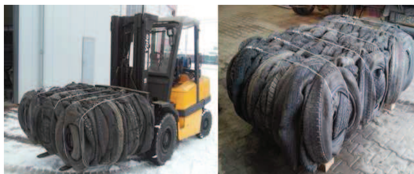
Rys. 3. Pakiety gumowe wykonane w ramach projektu badawczego ReUse [14]: z lewej transport, z prawej gotowy pakiet
