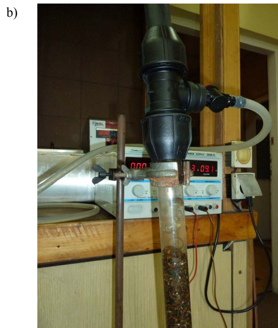
Rys. 3. Wlot powietrza i wody nasyconej H_2S do kolumny reakcyjnej (a), separacja wody oczyszczonej od odpadowego powietrza (b)
