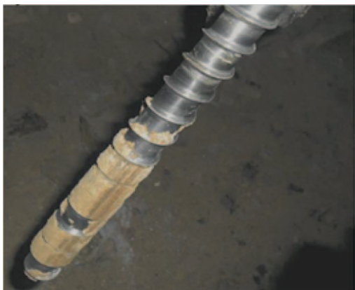
Rys. 6. Wrywanie (wyciąganie) kotew HMS-MX
