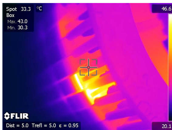
Rys. 9. Wirnik dwuklatkowy – termogram – zwarcie pręta klatki rozruchowej
