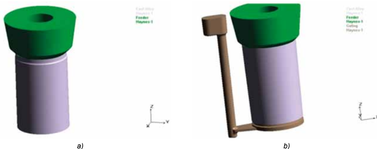
Rys. 3. Dwa warianty technologiczne (symulowane w programie MAGMA) odlewania dyszy palnika gazowego ze stopu H282 [2]: a) technologia zalewania przez nadlew, b) technologia z syfonowym układem wlewowym
