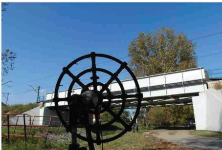
Rys. 9. Kamera akustyczna obok mostu i mikrofon pod konstrukcją
