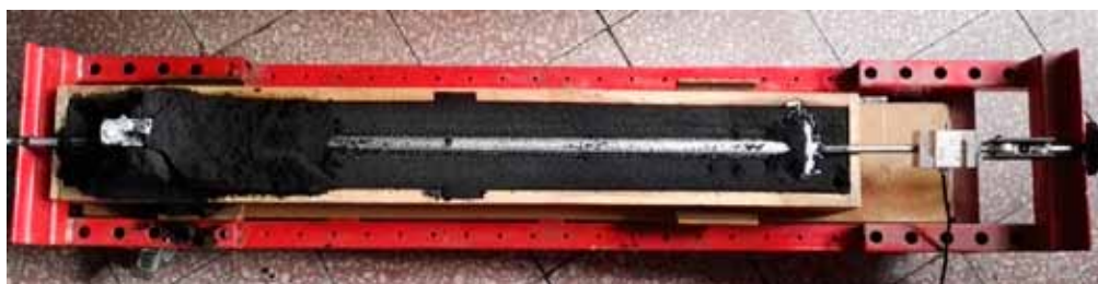
Rys. 14. Widok dolnej połowy formy po usunięciu górnej Fig. 14. Lower half of the mould, after removal of the upper half
