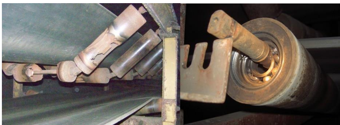
Rys.9. Przykłady przedwczesnego zużycia krążników [10]
