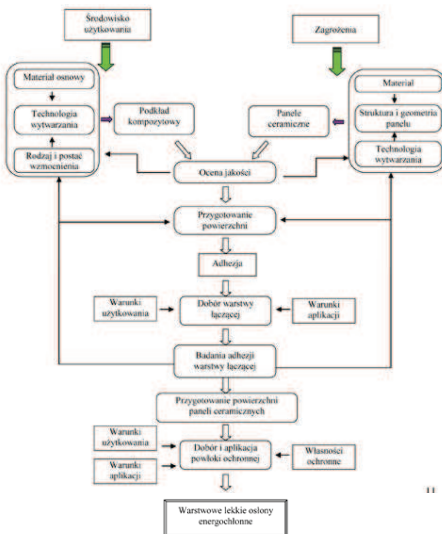
Rys. 6. Algorytm doboru materiałów na lekkie osłony energochłonne
