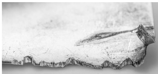
Rys. 2. Powiększony obraz uszkodzonej krawędzi natarcia łopatki sprężarki.
