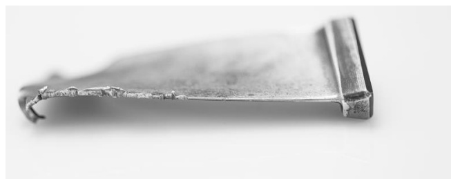
Rys. 1. Widok uszkodzonej łopatki sprężarki
