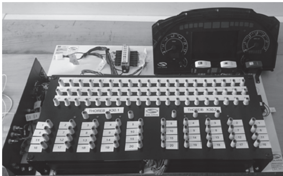
Rys. 4. Budowa stanowiska testowego systemu multipleksowego w autobusie
