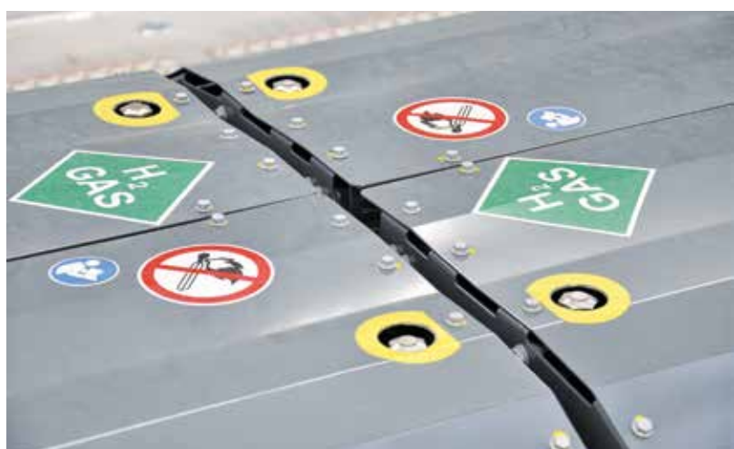
Zbiorniki na wodór na dachu pojazdu. Fot. J. Madryas
