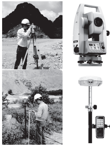
Fig. 4. Ground control points establishment using the GNSS and total station methods Rys. 4. Ustanowienie punktów kontroli naziemnej za pomocą metod GNSS i tachimetru
