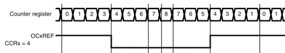
Rysunek 11. Sygnał porównania OCxREF, dla licznika TIM1 pracującego w trybie modulatora PWM z wyrównaniem do środka
