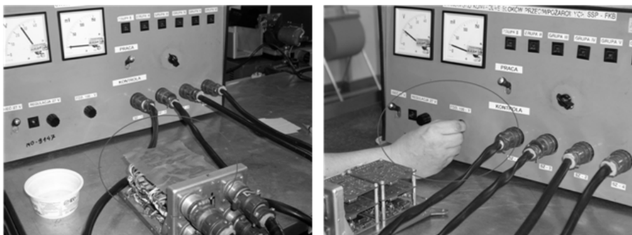
Rys. 6. Widok urządzenia do wprowadzania wilgoci (po lewej) oraz określania progów zadziałania (po prawej)
