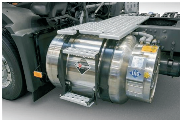
Fig. 5. Cryogenic LNG tank fitted on a truck Rys. 5. Kriogeniczny zbiornik LNG zamontowany na ciągniku siodlowym
