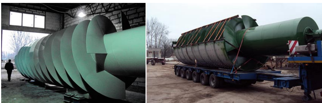
Rys. 10. Stopień wodny Lisi Ogon, transport turbiny Archimedesesa, Mewat Sp. z o.o. [2, 3]
