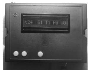
Rys. 4. Węzeł pomiarowy Fig. 4. Measuring sensor node
