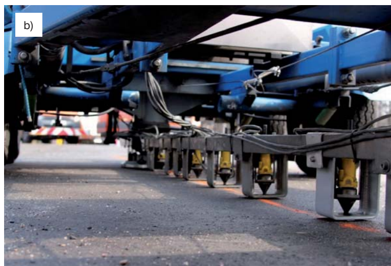
Fot. 1. a) Zestaw pomiarowy FWD; b) geofony pomiarowe na belce oraz płyta naciskowa
