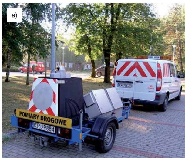
Fot. 1. a) Zestaw pomiarowy FWD; b) geofony pomiarowe na belce oraz płyta naciskowa
