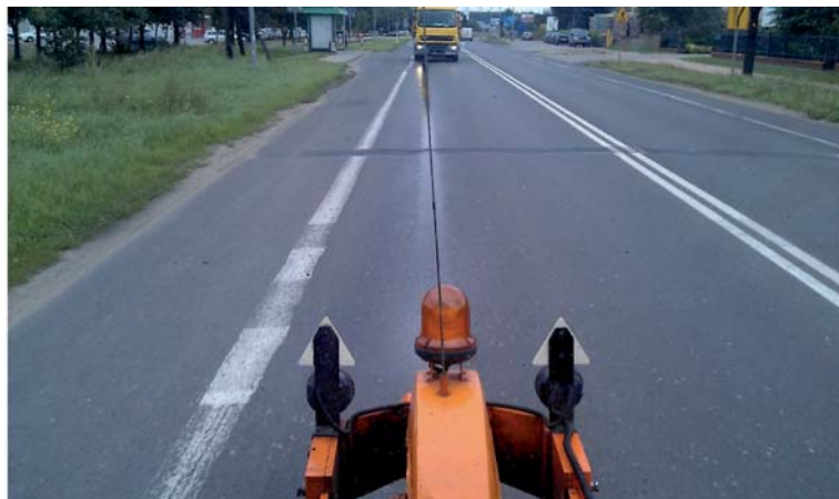
Fot. 3. a) Zestaw pomiarowy SRT-3; b) pomiar współczynnika tarcia nawierzchni wykonywany w prawym śladzie kół
