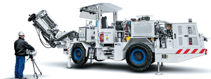
Rys. 5. Production Master 2.3 – wóz do wiercenia długich otworów
