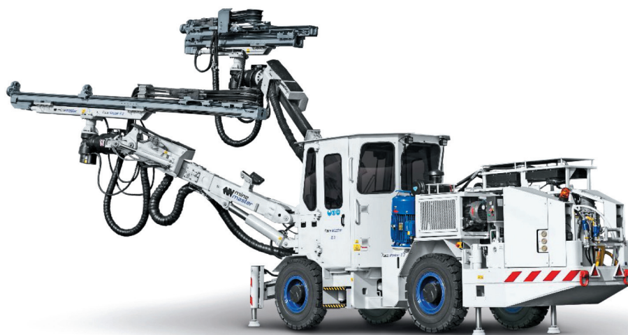
Rys. 3. Face Master 2.3 – dwuwysięgnikowy wóz wierzący
