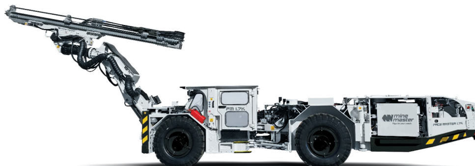
Rys. 2. Face Master 1.7K – wóz wierzący do niskich wyrobisk z klimatyzowaną kabiną
