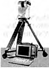
Ryc. 1. System pomiarowy Trimble Callidus przygotowany do pracy
