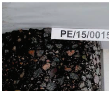
Fot. 6. Próbkę odwierconą w obszarze spękania podłużnego (widoczne spękanie tylko przez warstwę ścieralną) [7]
