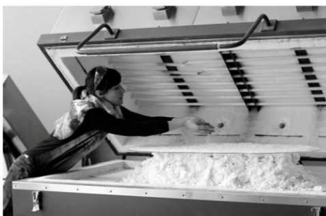
Rys. 14.2 Technika formowania w piecu elektrycznym
