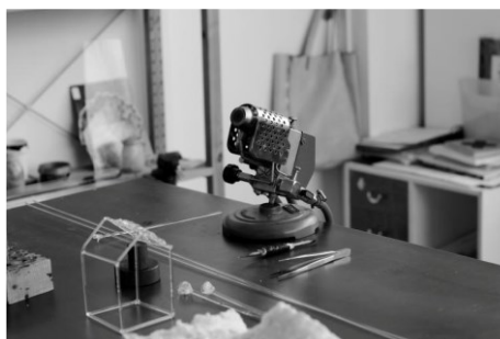
Rys. 14.3 Technika formowania szkła w ogniu palnika gazowego
