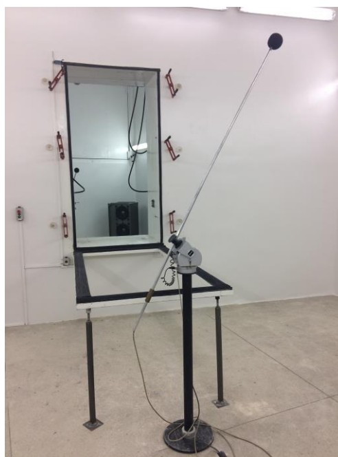
Rys. 1. Widok komory odbiorczej laboratorium Zespołu Komór Pogłosowych Sprzężonych, przeznaczonego do badań izolacyjności akustycznej właściwej.
