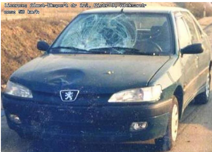
Rys. 8. Przykładowe pojazdy po zderzeniu z pieszym z EES Catalog. Źródło: EES Catalog. http://ees.vcrash3.com (dostęp 23.08.2015).
