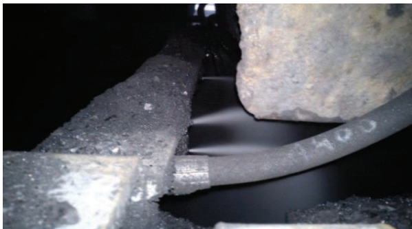
Rys. 8. System wytwarzający strumienie powietrzno-wodne, podczas prób [7]
