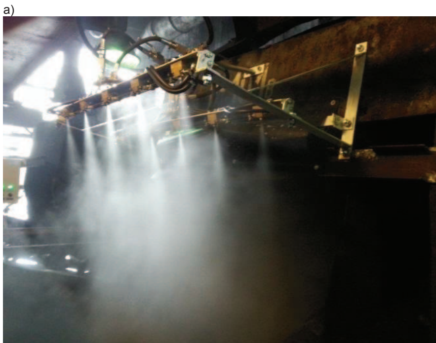
Rys. 15. System PASAT-W wytwarzający strumień zraszający [7]
