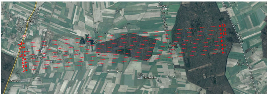
Rys. 6. Wyznaczona trasa lotu samolotu załogowego [K. Wodziński, 2014]
