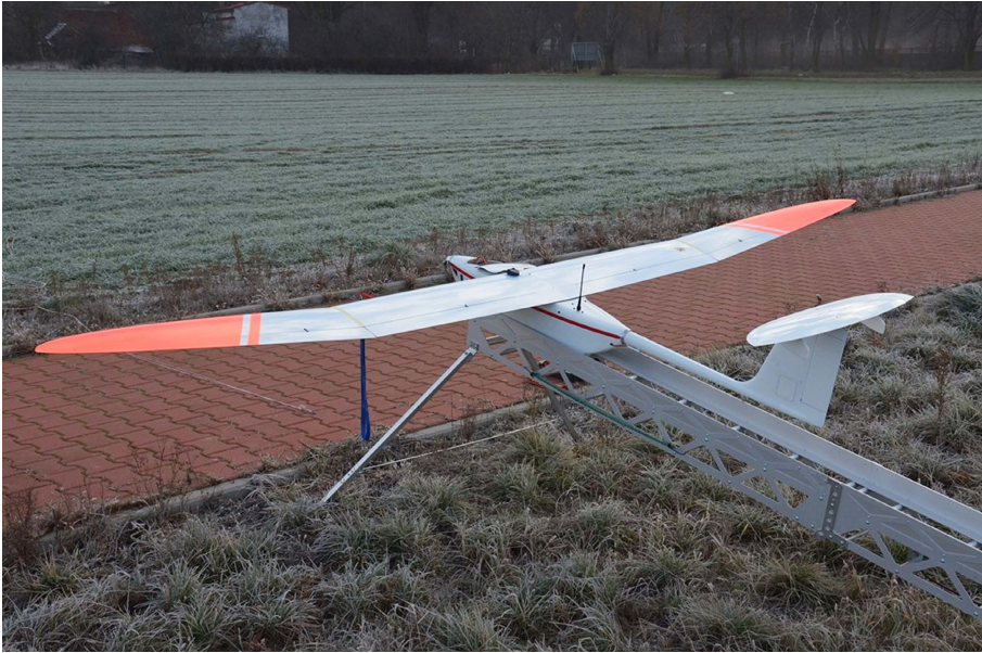
Rys. 3. Bezałogowy płatowiec przystosowany do pozyskiwania zdjęć [M. Kacprzak, 2013]
