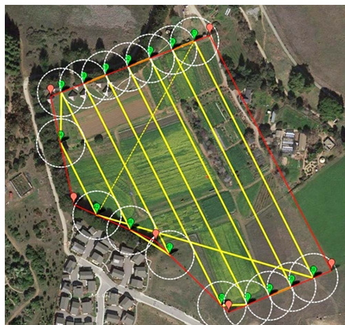
Rys. 2. Trajektoria lotu wielowirnikowca [2]
