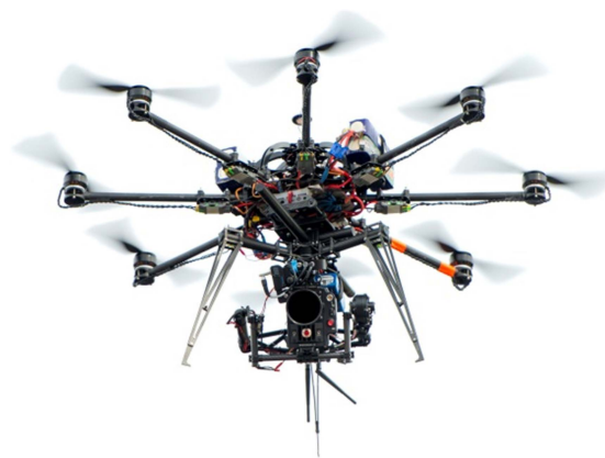
Rys. 1. Octocopter jako przykład platformy wielowirnikowej [1]
