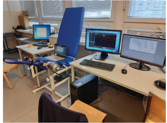
Rysunek 7. Stanowisko laboratoryjne z manipulatorem rehabilitacyjnym oraz komputerem z oprogramowaniem systemu wizyjnego OptiTrack
