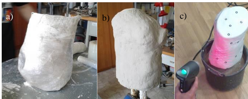
Rys. 3. Etap pierwszy: a) wykonanie negatywu; b) wykonanie pozytywu na podstawie negatywu; c) skan pozytywu z wykorzystaniem ręcznego skanera laserowego
