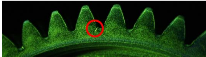
Rys. 3. Koło zębate poddane defektoskopii magnetycznej w świetle UV
