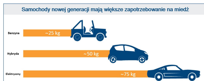
Rys. 2. Wykorzystanie miedzi w samochodach nowej generacji [Źródło: Opracowanie własne na podstawie Visual Capitalist, U.S. Global Investors] Fig. 2. Copper utilization in the new generation vehicles [Source: Own elaboration, based on Visual Capitalist, U.S. Global Investors]
