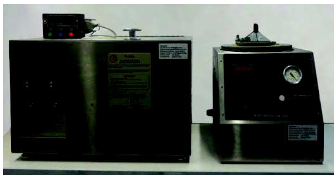
Fot. 3. Aparat PAV do badania starzenia eksploatacyjnego asfaltów
