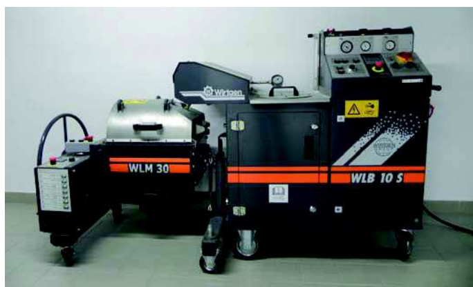
Fot. 5. Uniwersalne urządzenie laboratoryjne do badania spieniania asfaltów – WLB-10S
