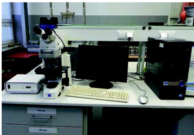
Fot. 7. Stanowisko badawcze z mikroskopem epifluorescencyjnym do oceny ilościowej oraz form (kształtów) cząsteczek modyfikatorów w asfalcie
