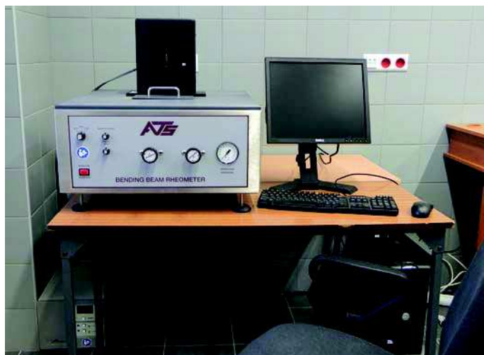
Fot. 4. Aparat BBR do badania asfaltów
