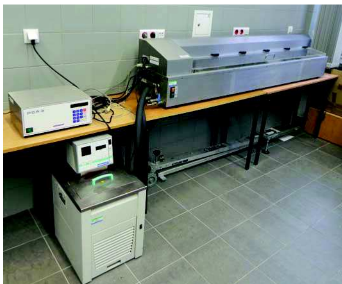
Fot. 2. Duktylometr z pomiarem siły rozciągającej
