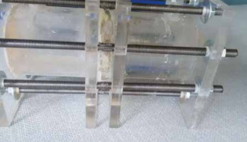
Rysunek 2. Komora dyfuzyjna do badania dyfuzji w stanie ustalonym. Po lewej stronie komora z nasyconym \text{Ca(OH)}_2 , po między komorami próbka, po prawej stronie komora z nasyconym \text{NaCl}
