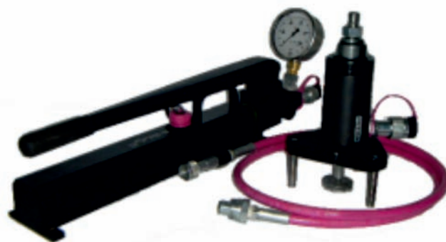
Rysunek 7 Przyrząd do badania przyczepności do podłoża Figure 7 Apparatus for testing of adhesion to the ground
