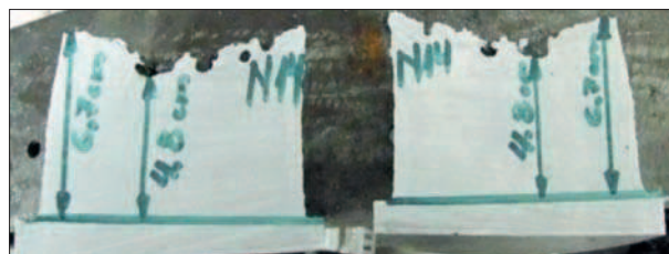
Rys. 12. Kształt jamy skurczowej wlewka, którego nadlew zaizolowano zasypką na bazie krajowej biomasy
