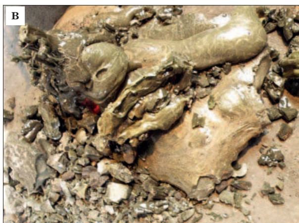
Rys. 15. Wytop w piecu szybowym; A – Spust żużla z pieca szybowego, B – wytopiony żużel
