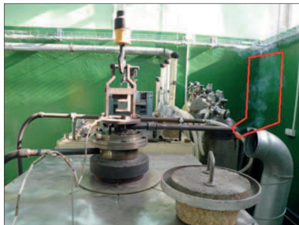
Rys. 9. Stanowisko do suchej destylacji odpadów zbożowych – widoczny dym będący efektem podgrzewania odpadów (zaznaczono czerwoną linią)
