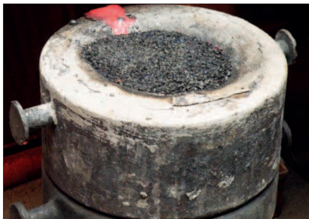
Rys. 11. Głowa wlewka pokryta zasypką izolująco-ocieplającą na bazie odpadów zbożowych
