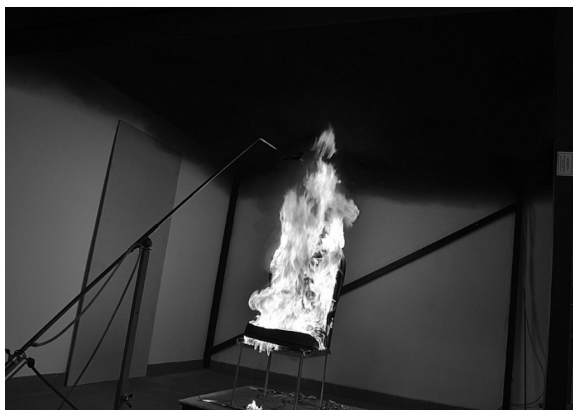
Rys. 6. Fotel numer 3 podczas badania na kalorymetrze meblowym (w czasie badania wydzielają się bardzo dużo dymu, co można zauważyć na fotografii) – fot. własna
