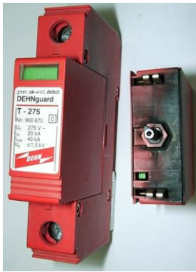
Rys. 1. Ogranicznik DEHNGuard (po prawej uszkodzona wkładka)
