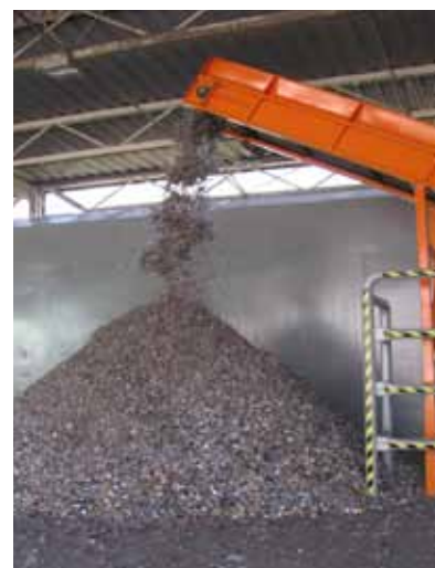
Rys. 4. Paliwo alternatywne z odpadów komunalnych po rozdrobieniu
