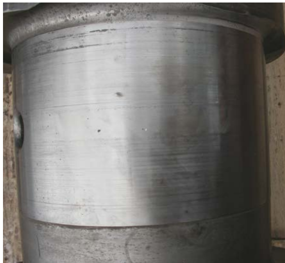
Rys. 2. Nadmiernie zużyty czop wału korbowego – widoczne rysy i bruzdy oraz stwierdzono błędy niekołowości
