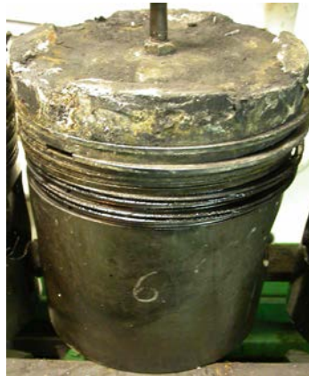
Rys. 4. Osady na tłoku stwierdzone w czasie przeglądu okresowego silnika
