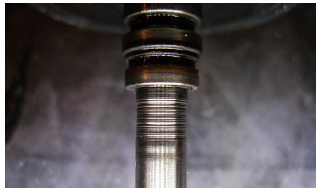
Rys. 1. Wałek turbosprężarki pokryty głębokimi rysami w miejscu współpracy z tuleją główną
