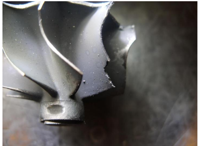
Rys. 12. Nadpalona łopatką koła turbinowego na skutek zbyt wysokiej temperatury spalin
