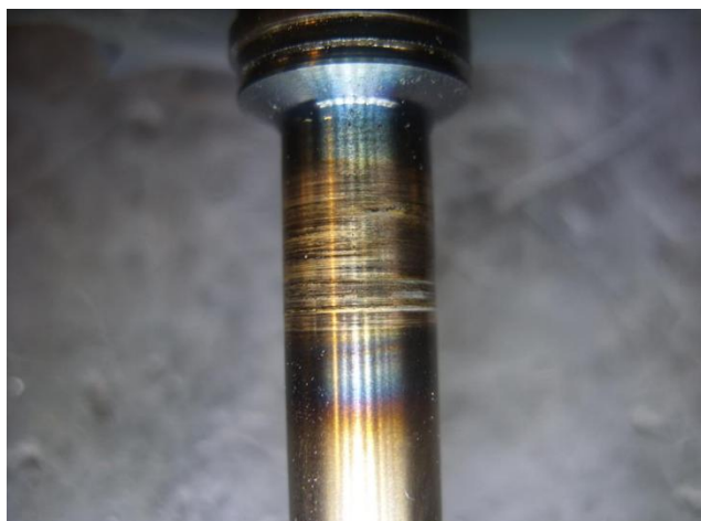
Rys. 3. Przytarty i przegrzany wałek turbosprężarki na skutek niewłaściwego smarowania
