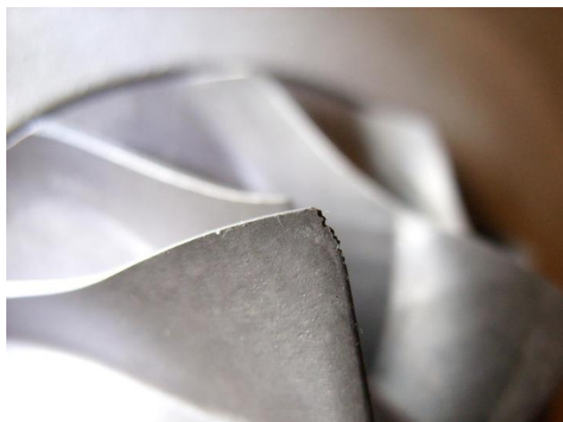
Rys. 6. uszkodzenie na skutek kontaktu z drobnymi twardymi zanieczyszczeniami znajdującymi się w zasysanym powietrzu.
