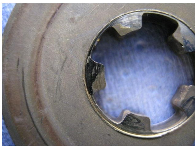
Rys. 4. Łożysko oporowe wytarte i przegrzane na skutek niewłaściwego smarowania.
