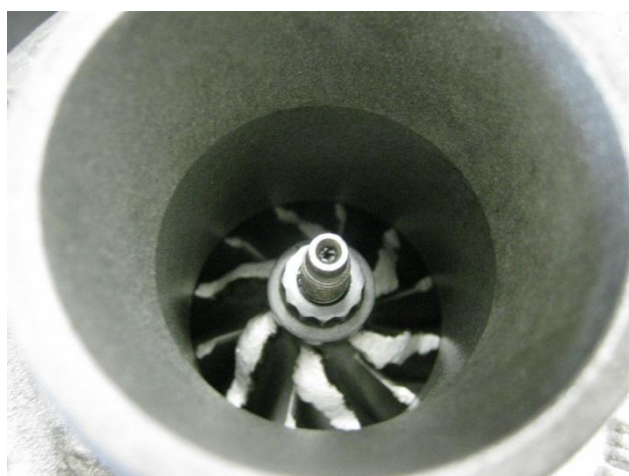
Rys. 7. uszkodzenie koła kompresji na skutek kontaktu z ciałem obcym większych rozmiarów.
