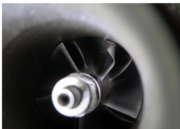
Rys. 8. Wygięcie łopatki koła kompresji na skutek kontaktu z miękkim materiałem znajdującym się w zasysanym powietrzu takich jak bryłka lodu lub element gumowy.
