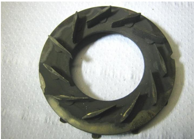
Rys. 11 Zablockowane kierownice zmiennej geometrii z powodu nagaru.
