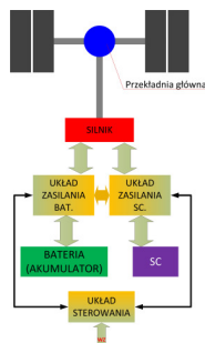
Rys. 4. Uproszczony schemat blokowy układu napędowego pojazdu elektrycznego zasilanego z akumulatora oraz układu z pomocniczego ze źródłem energii w postaci superkondensatora – SC. WZ – wartość zadana (wartość zadana prędkości).
