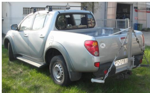
Rys. 6. Specjalny zaczep transportowy przeznaczony do holowania różnej średnicy bel biomasy [5]
