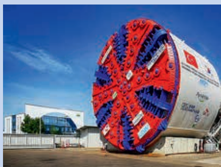
Ryc. 1. Urządzenie TBM o średnicy 13,6 m niemieckiej firmy Herrenknecht [2]
