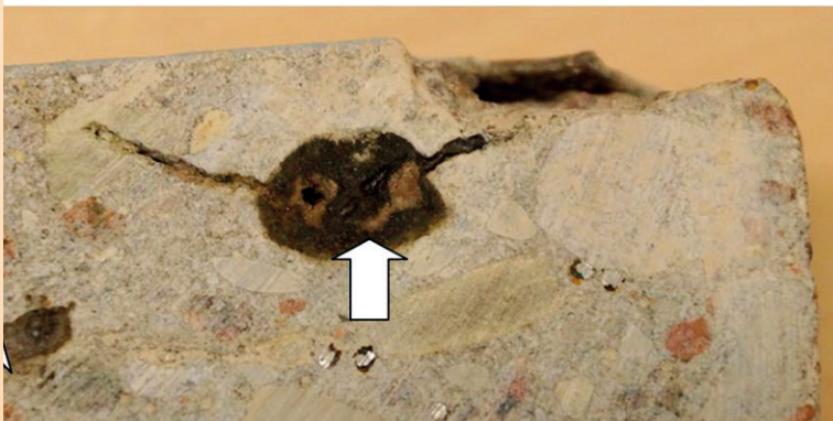
Fot. 2 (z lewej). Wyciekający żel alkaliczno-krzemionkowy – wielkość wycieku 2 mm (pobocznica odwiertu)
