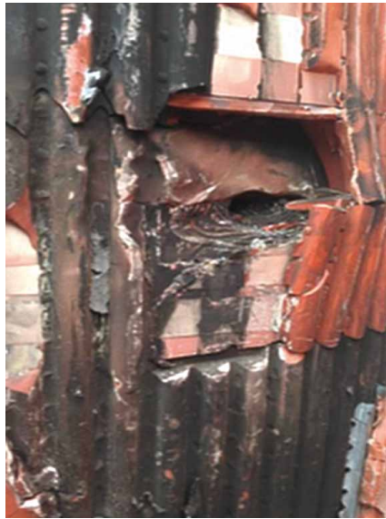
Rys. 3. Widok krateru eksplozywnego uzwojenia SN (fot. serwisu producenta)
