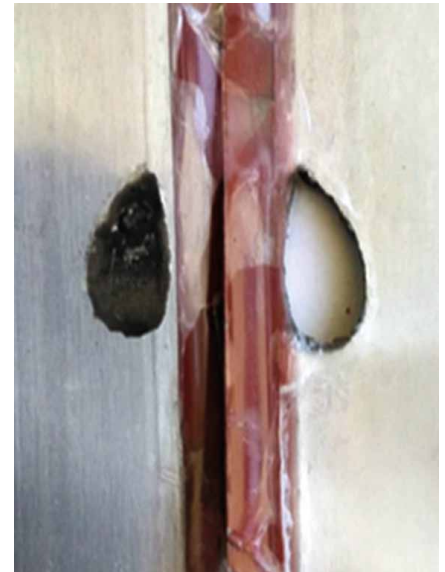
Rys. 4. Widok działania pierwotnej przyczyny awarii i źródło zwarcia międzwojowego (fot. serwisu producenta)
